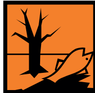
مادة ضارة بالبيئة Environmental hazard
